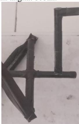
Gambar 10. Pegangan untuk Memutar Pengaduk (Sumber Gambar : Dokumen Pribadi)
