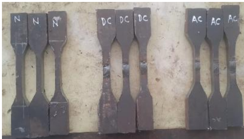
Gambar 3. Spesimen Uji Tarik
