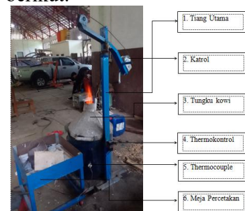
Gambar 33. Hasil Perancangan Tungku pengecoran logam alumunium
