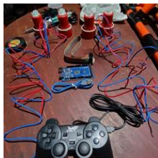
Gambar 4.23 Proses setting system pergerakan pendorong menggunakan joystick yang terhubung ke mikrokontroler dan Motor driver sumber : dokumen pribadi
