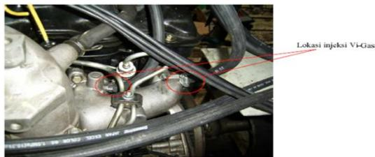
Gambar 3.15 lokasi injeksi Vi-Gas pada saluran udara masuk
