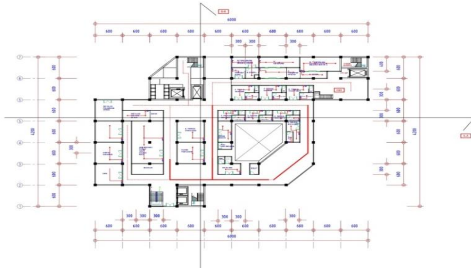
Gambar 12. Denah Instalasi listrik
