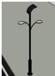
Gambar 12 Lampu Jalan Menggunakan Panel Surya
