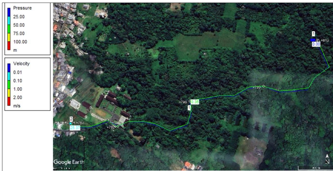
Gambar 1. Hasil analisis perangkat lunak EPANET pipa transmisi
