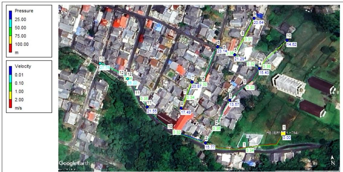
Gambar 2. Hasil analisis perangkat lunak EPANET pipa distribusi
