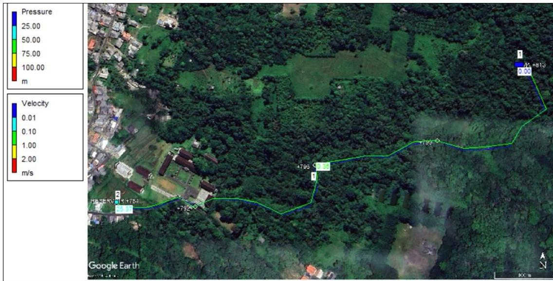
Gambar 1. Hasil analisis perangkat lunak EPANET pipa transmisi
