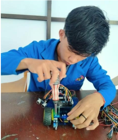
Gambar 10. Proses pemasangan sumber tenaga
