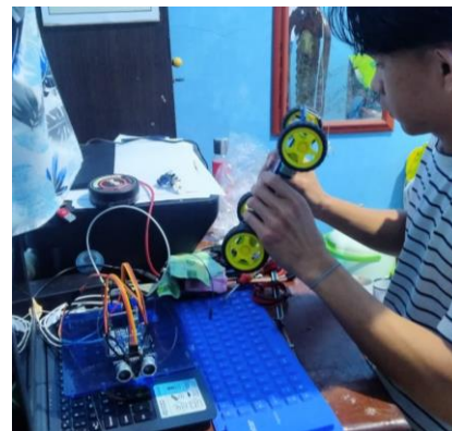
Gambar 13. Pemasangan driver motor, servo dan kontroler
