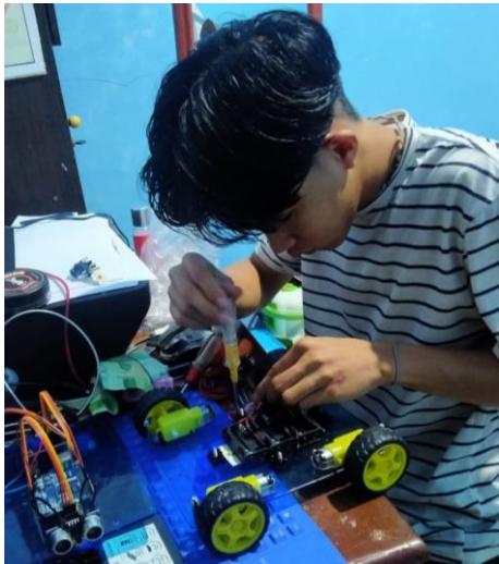
Gambar 11. Pemasangan motor dc
