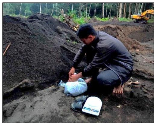
Gambar 4. Survey dan Pengambilan Sampel Awal Agregat Halus
