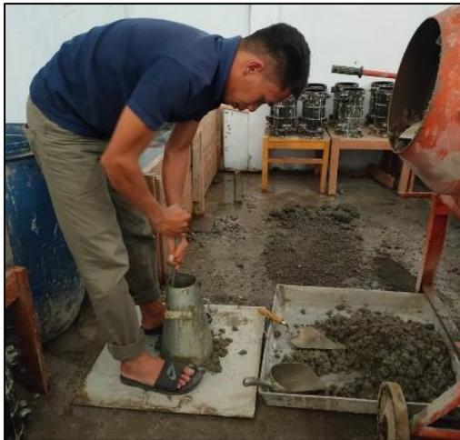
Gambar 6. Pengujian Slump beton segar
