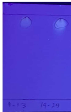
Gambar 2. Pelat KLT F_{1.2.1} dan F_{1.2.2} disinari lampu UV pada panjang gelombang 366 nm
