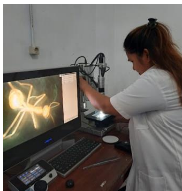
Gambar 4. Pengamatan morfologi menggunakan mikroskop 3d Hirox KH8700.
